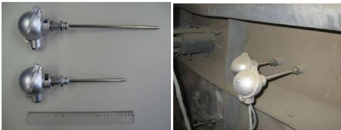
Abbildung 1: Jeder der PiT CoatingDetector besteht aus je zwei Temperatursensoren mit unterschiedlicher Einstecktiefe (links im ausgebauten Zustand). Sie werden von außen am Steigschacht installiert und liefern Temperaturdaten von Wand und Ausmauerung (rechts im eingebauten Zustand).
